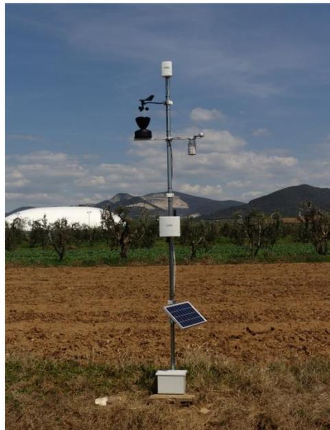
Figura 5. Stazione meteorologica installata presso l'oliveto intensivo utilizzato per il trasferimento di protocolli irrigui innovativi a San Vincenzo (LI).
