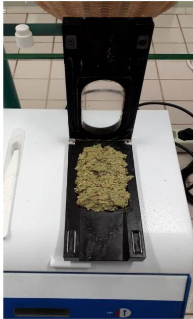
Figura 16. CropScan 2000B NIR Analyser (NIR Systems, Australia) utilizzato per la determinazione del contenuto in olio e di umidità della pasta di olive.
