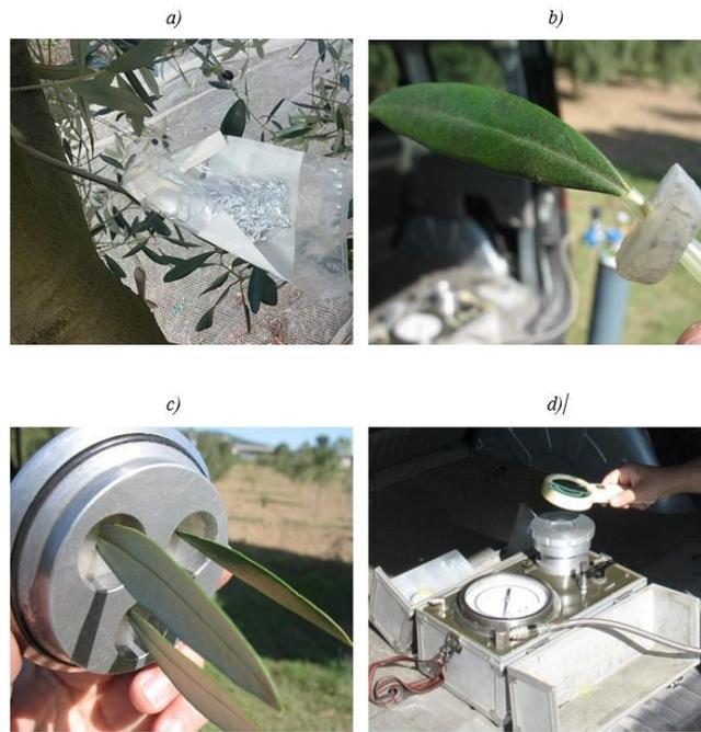
Figura 6. Fasi preparatorie per la misurazione del potenziale idrico del fusto: a) foglia oscurata per bloccare la traspirazione prima della misurazione dello SWP. b) dettaglio di guarnizione per adattare il foro alle foglie di olivo. c) foglie pronte per essere inserite nella camera a pressione. d) Camera a pressione tipo Scholander, utilizzata per misurare il potenziale idrico del fusto.
