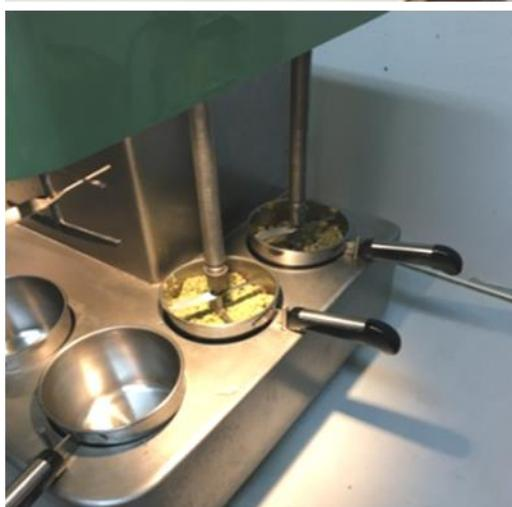
Figura 17. Mini-frantoio utilizzato per le frangiture differenziate di olive raccolte dai singoli alberi in prova presso l'Azienda Agricola Roncareggi a San Vincenzo (LI).
