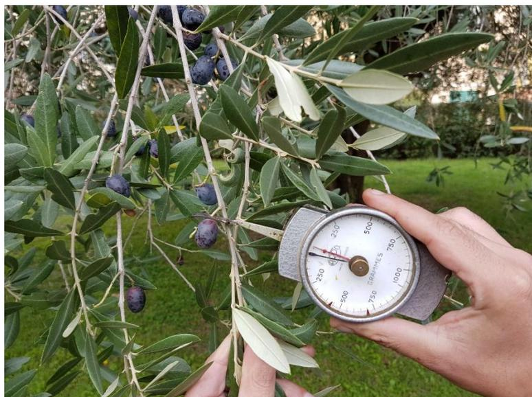
Figura 9. Dinamometro utilizzato per la misura della forza di ritenzione del frutto.
